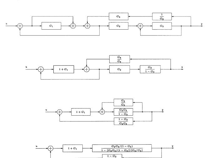
$$\frac{u}{1 - ((1+G_1)G_2G_3/(1-G_3-G_2G_4))} \frac{y}{1 - ((1+G_1)G_2G_3/(1-G_3-G_2G_4))((1-G_3)/(G_2G_3))}$$
